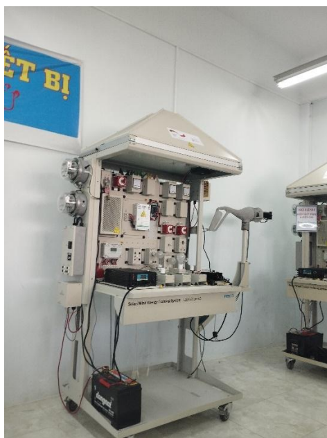
Hình 12: Hệ thống đào tạo Điện mặt trời và gió tại NTVC
