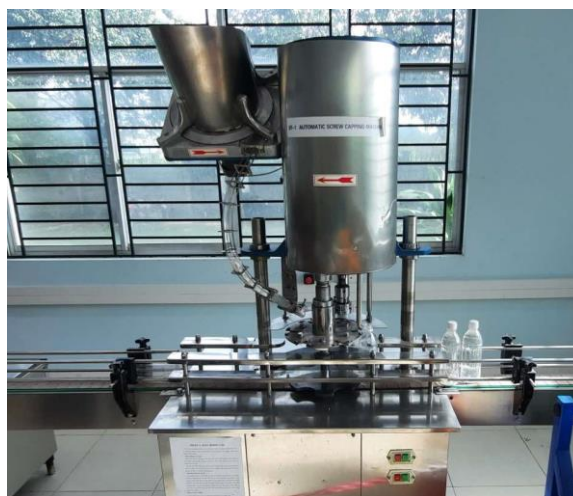
Hình 63: Trạm đóng nắp
