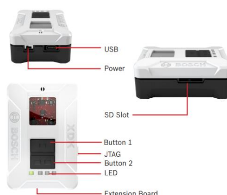
Hình 98: Cấu trúc cảm biến XDK
