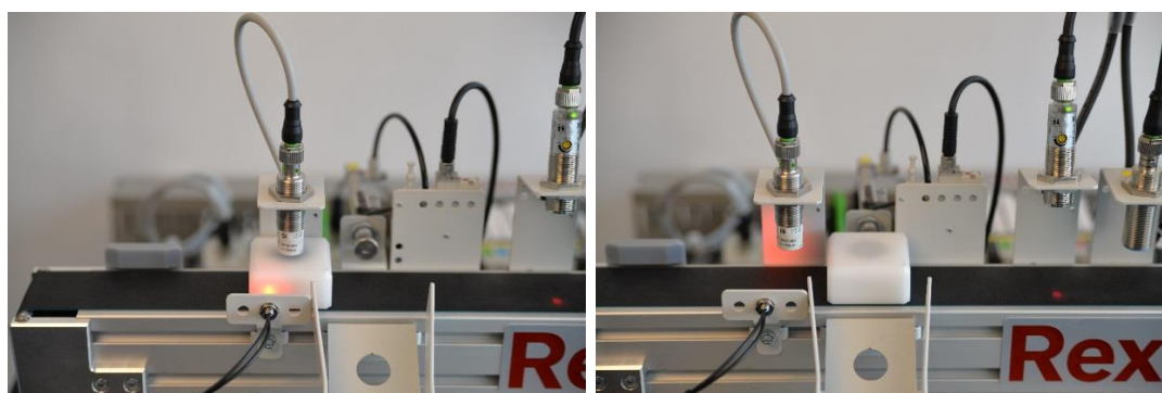
Hình 59: Dây dẫn ánh sáng dừng hình khối dưới ăng-ten RFID (trái) và hình khối sai ở vị trí đẩy ra (phải)
