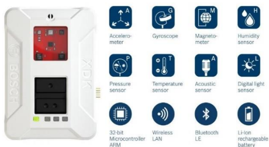
Hình 67: Chức năng cảm biến XDK
