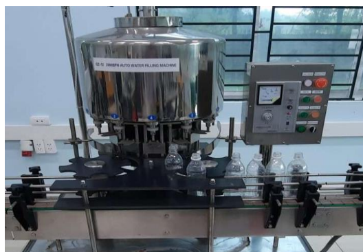
Hình 62: Trạm chiết rót
