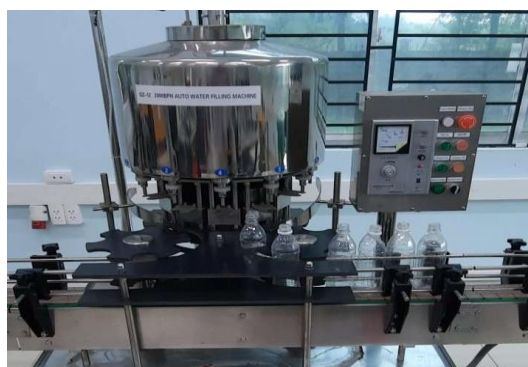
Hình 81: Trạm chiết rót
