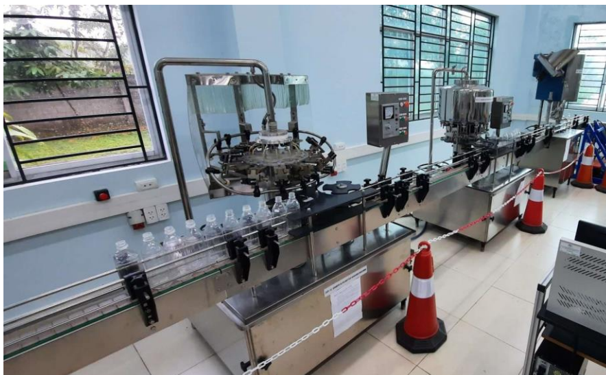
Hình 60: Thiết lập đầy đủ trạm đóng chai, làm sạch (trái), chiết rót (giữa) và đóng nắp (phải)
