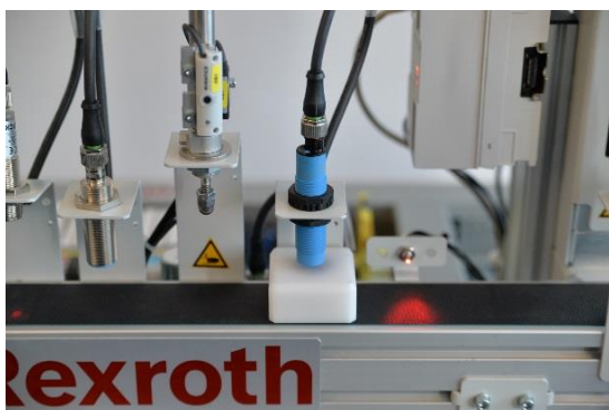
Hình 75: Khối lập phương được phát hiện bởi cảm biến điện dung
