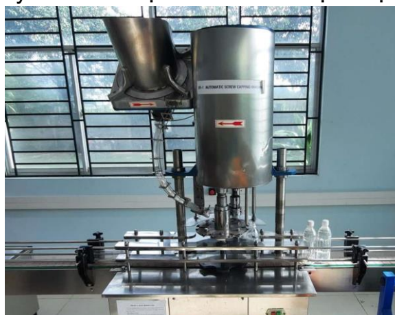
Hình 82: trạm đóng nắp
