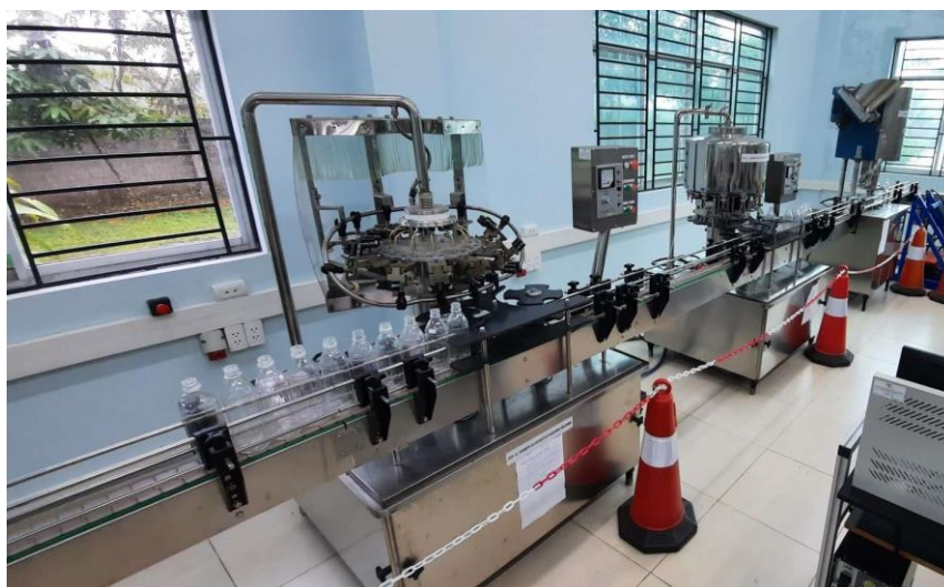
Hình 79: Thiết lập đầy đủ trạm đóng chai, làm sạch (trái), chiết rót (giữa) và đóng nắp (phải)
